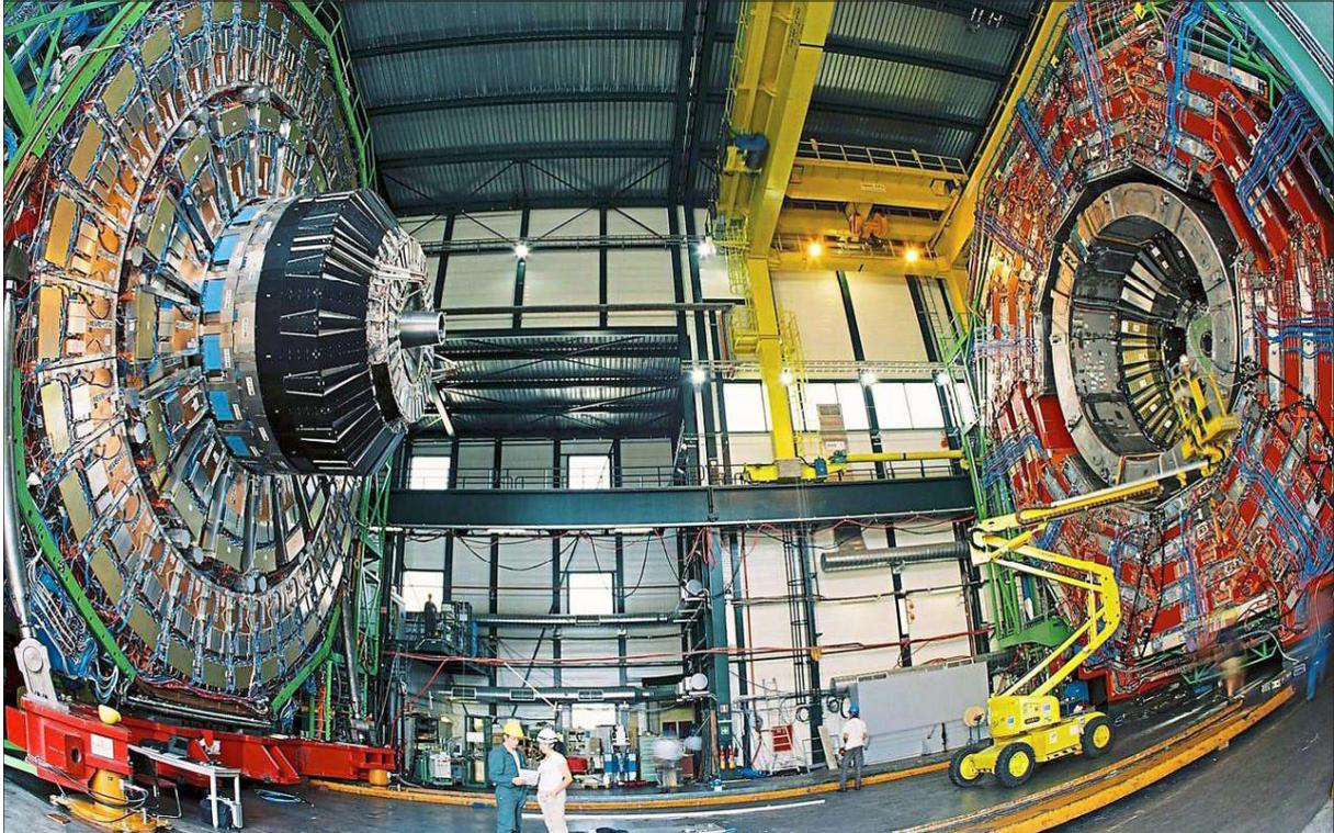
Der Teilchendetektor des CMS (Compact Muon Solenoid)-Experiments ist mit 14 000 Tonnen der schwerste Teilchendetektor, der jemals an einem Beschleuniger gebaut wurde. Er ist Teil des Beschleunigerings LHC im Teilchenphysiklabor Cern, wo Fabian Batsch forscht. Im LHC-Ring wurde 2012 das Higgs-Teilchen entdeckt. Foto: CERN
